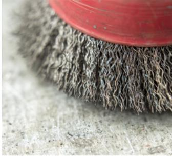
2 Untergrund vorbereiten durch Reinigung mit Drahtbürste und/oder Staubsaugen
