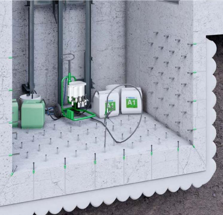
Eine Schleierinjektion mit KÖSTER Injektionsgel G4 ermöglicht eine Abdichtung der Positivseite ohne Aushub. Das Gel wird von innen nach außen durch die Wand injiziert. Das Injektionsmaterial wird an der Außenwand verteilt und reagiert in kurzer Zeit unter Bildung einer elastischen Abdichtungsbarriere auf der Positivseite.
